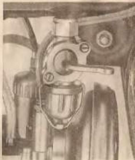
На мотоцикле Т-5 установлен трехпозиционный бензиновый кран, комбинированный с отстойником. В трех разных позициях бензиновый кран действует согласно нижеизложенному:
