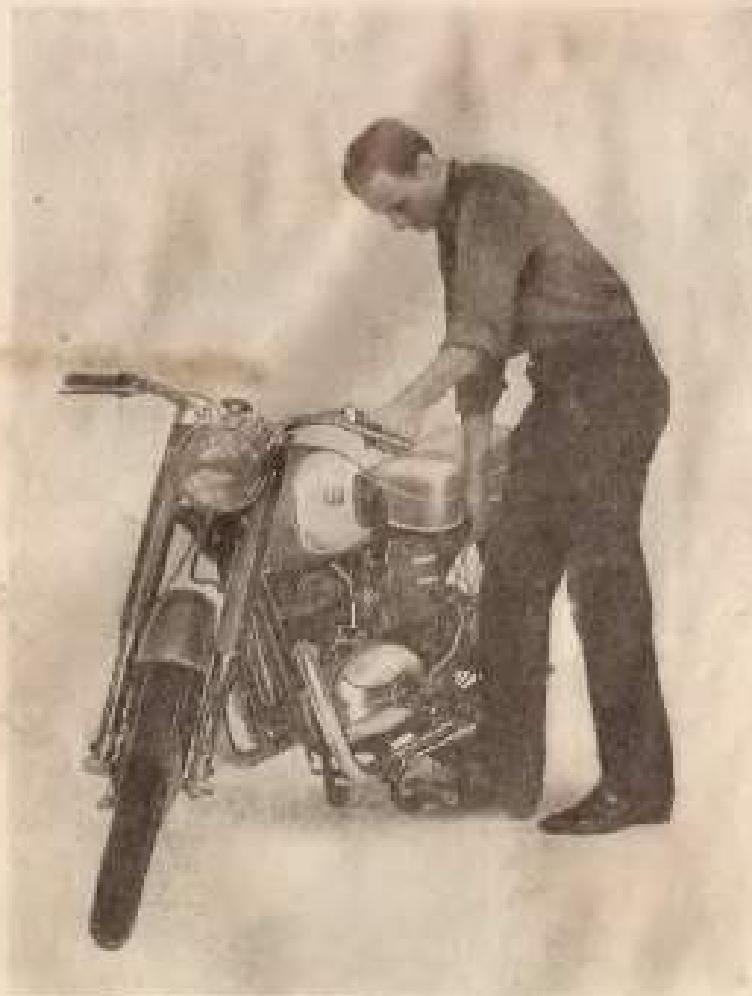
Передняя вилка выполнена без гидравлики с конструкцией, имеющей пружину, закрепленную на двух концах. Подпрессоривание и амортизация производится двумя передними пружинами вилки. Поскольку по какой-либо причине потребуется замена пружин или же разборка вилки, то она должна производиться следующим образом.
