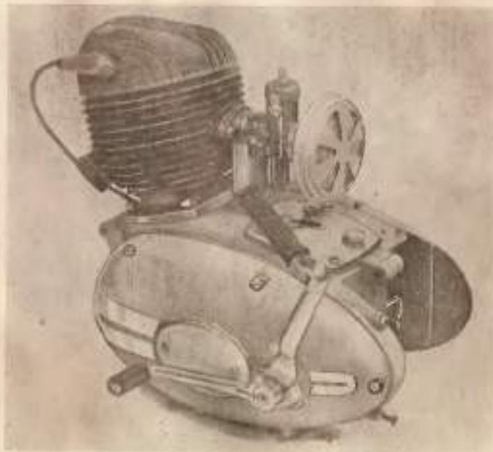
Двухтактный одноцилиндровый двигатель с поршнем с выпуклой головкой и петлевой продувкой. Изготовленный из высокопрочной алюминиевой отливки картер двигателя состоит из нескольких частей.
