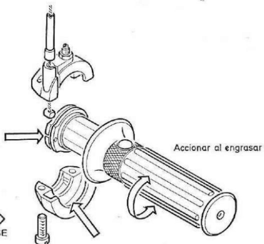
2. **Cambio del conjunto cable-funda del gas.** Para cambiar el cable del gas desmontar la tapa superior del carburador para liberar la válvula de gas unida al cable. Téngase en cuenta la posición del clip en la aguja antes de desmontar el conjunto. Separar el cable de la tapa superior.
